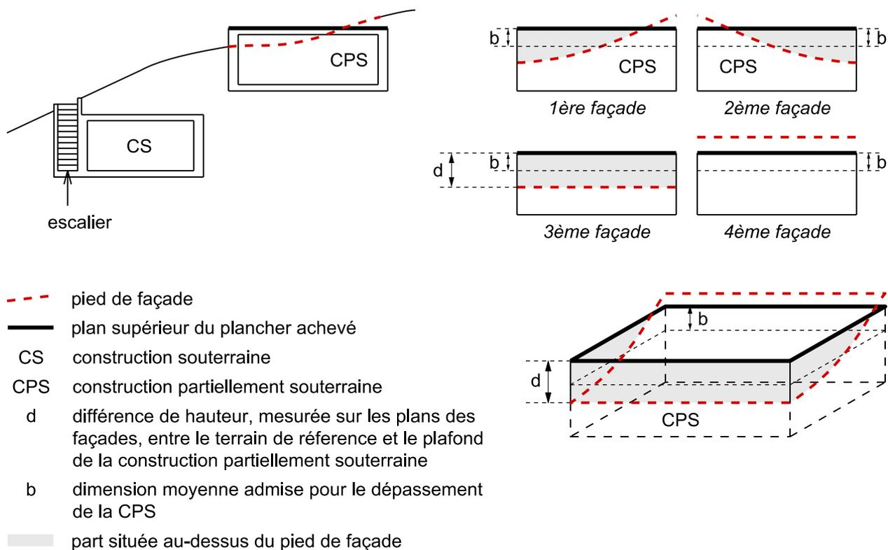
Figure 2.4 et 2.5 Constructions souterraines, constructions partiellement souterraines
