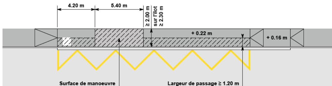
Lorsque la hauteur de la bordure d'accostage est de 16 cm (accès à l'aide d'une rampe), la largeur nécessaire augmente de 0.9 m, passant à 2.90 m, étant donné que la rampe empiète sur la surface de manœuvre.
