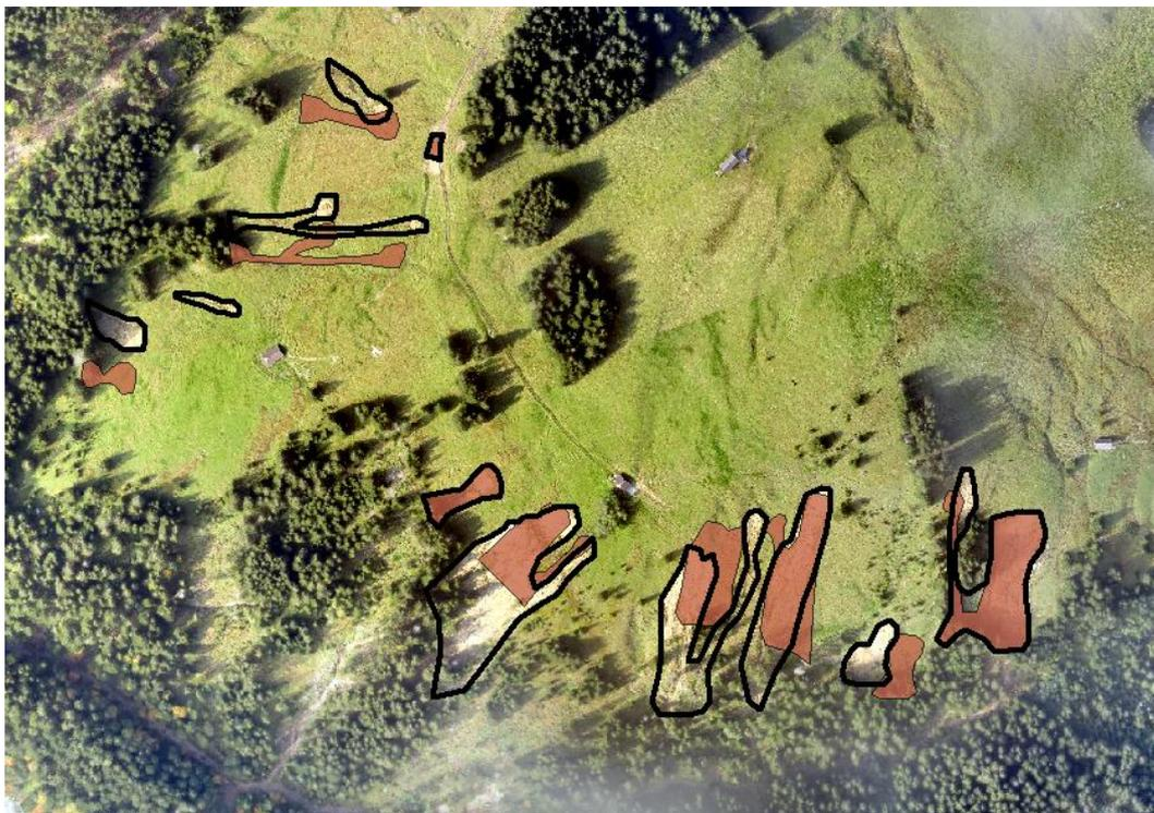
Abbildung 19: Orthophotos obtenues à partir d'un vol de drone. Les surfaces brunes montrent les surfaces StorMe cartographiées sans la photo aérienne. Les traits noirs montrent les surfaces réelles de ces glissements
