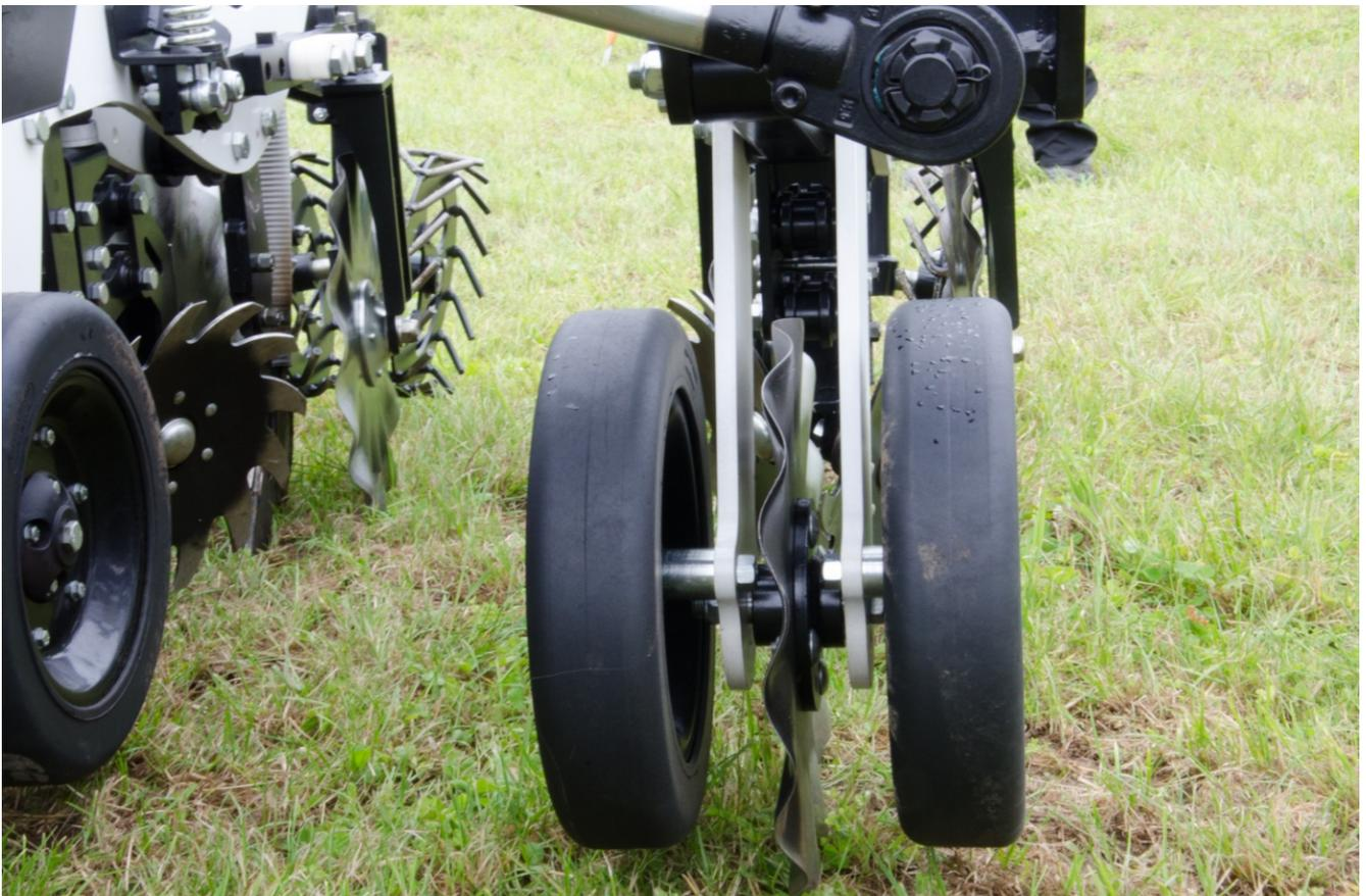
Abb. 8: Mit Strip-Till wird nur die Bodenpartie bearbeitet, in welcher gesät wird. Bild: Grangeneuve
