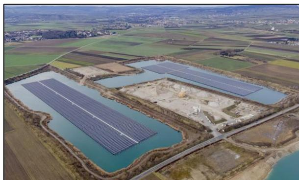
L'installation photovoltaïque flottante sur le lac artificiel des Toules (VS) avec une puissance de 448 kW - si le projet s'avère concluant, l'installation sera agrandie d'un facteur de 30 (à droite). La plus grande installation photovoltaïque flottante (24 MW) en Europe centrale se trouve à Grafenwörth en Autriche – elle est mise en service au mois de février 2023. Sources : Romande Energie et ECOwind
