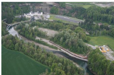
Die vorbereitenden Massnahmen für die Sanierung der Deponie wurden 2014 abgeschlossen. Die Fassung des Grundwassers oberhalb der Deponie, die teilweise Isolierung der Deponie durch eine Spundwand sowie das Abpumpen des Deponieabwassers und dessen Behandlung haben dazu beigetragen, dass der Schadstoffeintrag in die Saane deutlich reduziert werden konnte.
